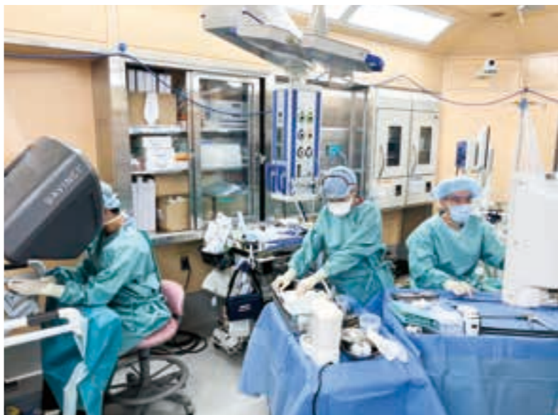
内視鏡手術支援ロボット(da Vinci)手術は、精密なカメラや鉗子を持つ手術用ロボットを遠隔操作して行う方法です。
